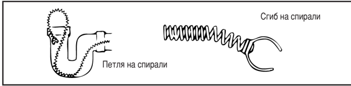
Рис. 4 - Обеспечение сохранности спирали и сгиб на спирали для быстрой прочистки
